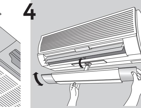
エアコンの風向きに合わせて本体の角度と伸縮カバーの長さを調節します。
